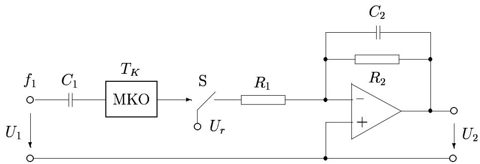
Obvod pracuje následovně: na vstup  $U_1$  přivádíme pulsy o frekvenci  $f_1$ . Těmito pulsy je spouštěn monostabilní klopný obvod MKO s dobou nestabilního stavu  $T_K$ , který řídí spínač S. Pomocí spínače je na vstup integrátoru přiváděno na dobu  $T_K$  referenční napětí  $U_r$ , které je integrováno. Takto zpracované napětí odebíráme na výstupu  $U_2$ .
